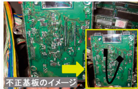
写真6 不正サブ基板 狙われる基板の裏側イメージ
