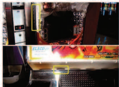
写真2 エレコ(赤ドン雅)セル挿入箇所
