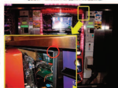
写真7 SANKYO セル挿入箇所(セル返しが無い)
