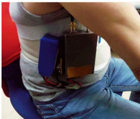
写真3 本体とバッテリーは腹に巻きつけている
