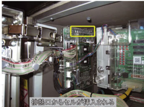
写真2 「豪炎高校」 狙われる箇所 サブ基板 (排熱口からセルを挿入)
