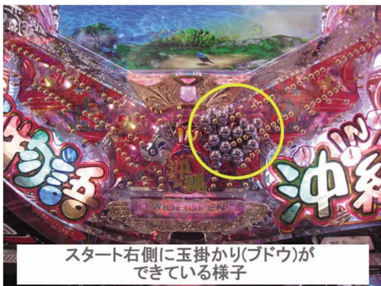
磁石センサーの検知範囲外の箇所 に磁石を置いて玉掛かり(ブドウ)を作成
