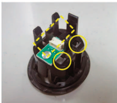
写真4「MAXBET基板」基板を固定するツメの破損跡
